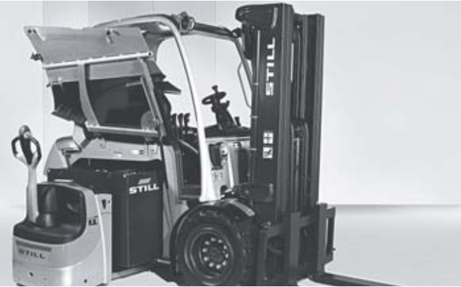
Einfacher seitlicher Batteriewechsel mit Niederhubwagen und Batteriewechselgestell
