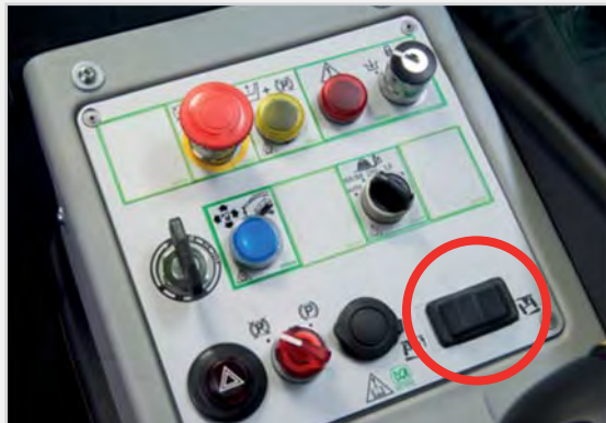
Steuerung des Niveaus ausgleichs auf dem Armaturen Brett vor dem Joystick
